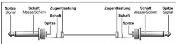
Abb. 5.1: Unsymmetrisches Klinkenkabel mit Monoklinkensteckern
