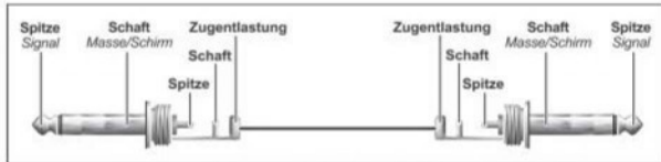
Abb. 5.1: Unsymmetrisches Klinkenkabel mit Monoklinkensteckern
