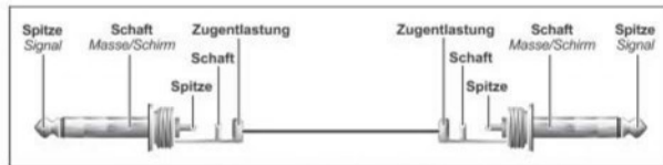
Abb. 5.1: Unsymmetrisches Klinkenkabel mit Monoklinkensteckern
