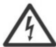
Dieses Symbol verweist auf das Vorhandensein einer nicht isolierten und gefährlichen Spannung im Innern des Gehäuses und auf eine Gefährdung durch Stromschlag.
